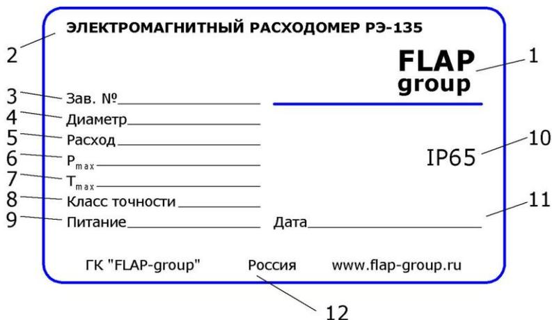
**Рисунок 1.3** – Внешний вид таблички расходомера
